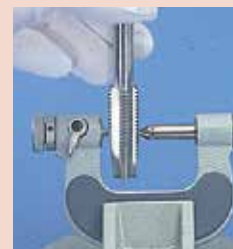
Anvil-spindle tip set:
